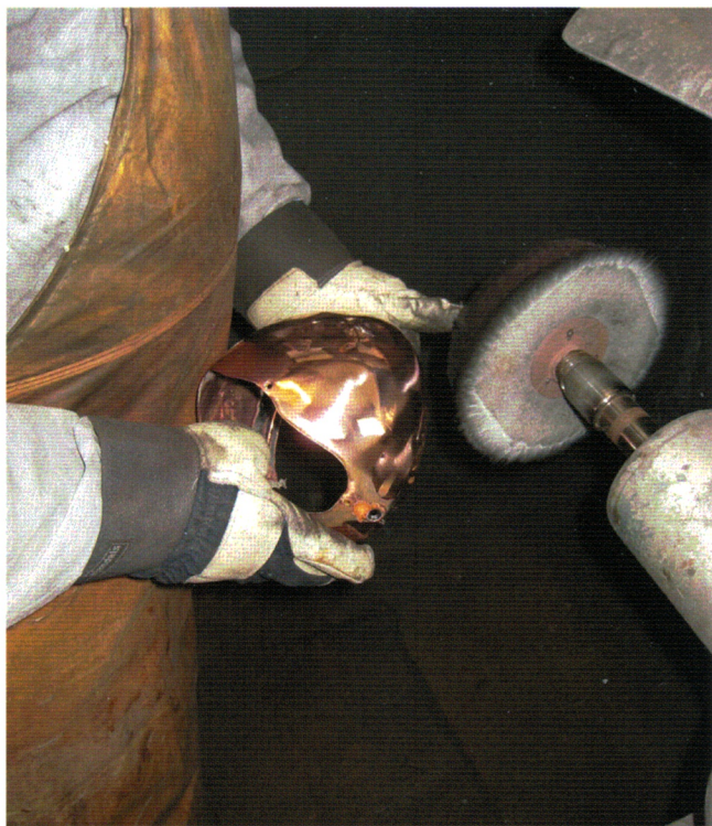
POLERING AV ET LYKTEHUS
